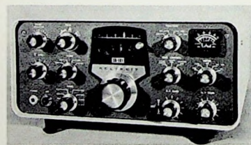
▲ Bild 1. Blick auf die Bedienelemente des Transceivers; links die Abstimmung des Sendeteils (z.B. Treiber, PA, Antenne, Mikrofonpegel) und rechts die Umschaltung des Meßwerkes mit S-Meter, HF-Regler und Lautstärkereger
